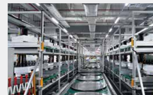
W pełni automatyczny system testowy dla dużych maszyn
